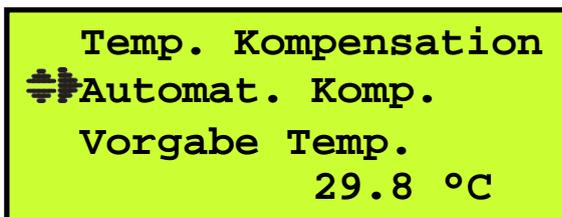
Mit der Taste
