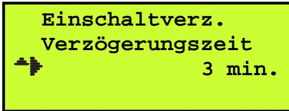
Bei einem Netzspannungsausfall wird die Regelung um die einstellbare Zeit verzögert. Mit der Einstellung 0 min. ist die Verzögerungszeit abgeschaltet.
