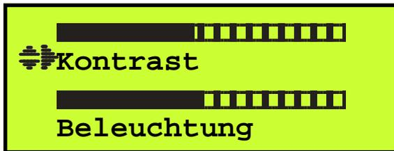
Über die Kontrasteinstellung ist es möglich, die Kontraststärke der LCD-Anzeige zu variieren.
