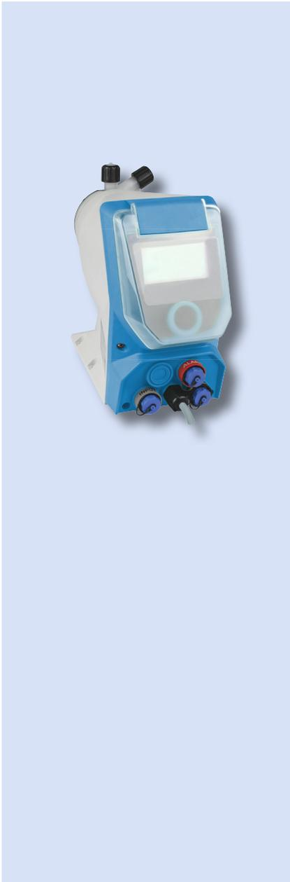
Schrittmotor-Membrandosierpumpe zur Dosierung flüssiger Medien mit sehr hoher Genauigkeit. Das Turndown-Verhältnis von 1:4800 sorgt für eine präzise und gleichmäßige Dosierung. Der Slow-Motion Modus ermöglicht auch eine Dosierung von höherviskosen Medien bis 10.000 CPS.
