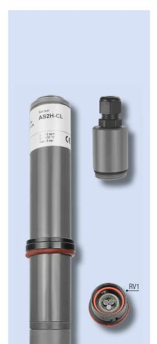
Sensor zur Erfassung des freien, anorganischen Chlors mit offener Messzelle. Optional mit Reinigungsvorrichtung RV1. Amperometrisches, 3-Elektrodensystem mit potentiostatischer Beschaltung.
