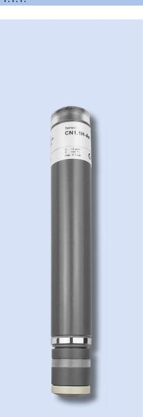
Überprüft die Abwesenheit von Chlor in Wasser mit Trinkwasserqualität, zum Schutz von Aggregaten, max. Betriebszeit in chlorfreiem Wasser bis zu 4 Wochen. Membranbedecktes, amperometrisch arbeitendes potentiostatisches 3-Elektrodensystem mit integrierter Elektronik.
