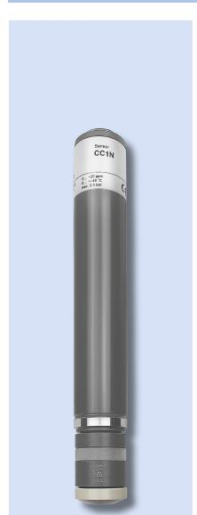
Sensor de cloro con sistema amperométrico de medición de 3 electrodos y recubierto con membrana, con una menor dependencia del pH. Para detección de cloro libre en base al ácido isocianurico, pueden ser utilizados también en agua de mar.
