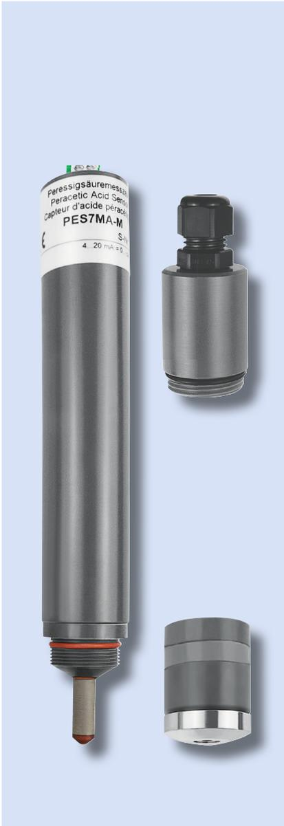
Sensor para detección de ácido peracético (C<sub>2</sub>H<sub>4</sub>O<sub>3</sub>), con sistema amperométrico de medición de 2 electrodos y recubierto con membrana. Tolerancia de soluciones de hasta 1% de ácido sulfúrico y ácido nítrico, los tensioactivo son parcialmente tolerados.
